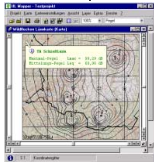
Abb. 1 Ansicht einer Lärmkarte im Modul Mapper mit Anzeige der Pegelwerte an der Cursor-Position
