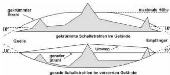
Abb. 2 Schematische Darstellung der Betrachtungsweise mit gekrümmten Strahlen über Gelände (oben) und mit geraden Strahlen über dem entsprechend verzerrten Geländeschnitt (unten)
